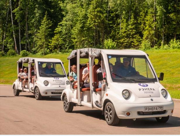
زودت شركة RENERA حديقة باتريوت ذات الطابع العسكري في كوينكا (منطقة موسكو) بست سيارات كهربائية لمشاهدة معالم المدينة، وهي مجهزة ببطاريات جر Li-ion. توفر بطارية Li-ion التي تبلغ استطاعتها ٢٦ كيلو واط ساعي التي تنتجها شركة RENERA أقصى مدى يصل إلى ١٠٠ كيلومتر. يمكن شحن البطارية باستخدام مخرج ٢٢٠ فولط قياسي. تستغرق عملية الشحن من ٦ إلى ١٠ ساعات حسب عمق التفريغ. يمكن للسواح، نظرًا لأن السيارات الكهربائية لا تصدر أي انبعاثات وتعمل بلا ضوضاء تقريبًا، الاستمتاع بتفريغ الطيور وحفيف أوراق الشجر في الحديقة.
