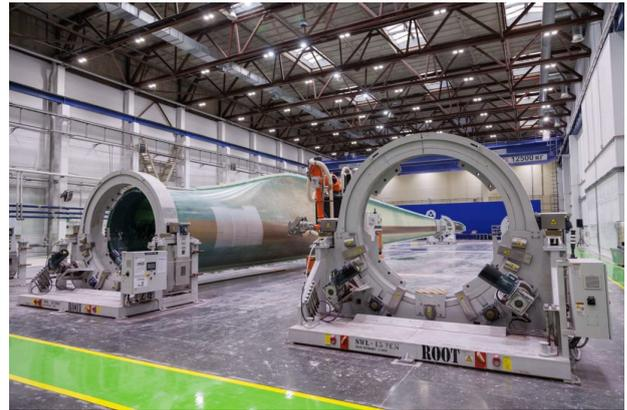
La calidad de la unión se verifica con un detector de defectos y una cámara termográfica. En la pala ensamblada se mecanizan los casquillos de fijación, se laminan las uniones adhesivas, se verifican los parámetros geométricos, se aplica la masilla, luego se realiza la pintura, el pesaje, se hace el balanceo y, finalmente, se envía al almacén de productos terminados.
