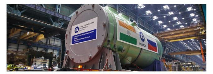
O vaso do reator VVER-1000 pesando 320 toneladas para a sexta unidade de energia da Usina Nuclear de Kudankulam foi fabricado pela planta Atommash (parte da Divisão de Construção de Máquinas da Rosatom). De Volgodonsk, onde a usina está localizada, o vaso do reator foi entregue por um veículo especial ao píer da usina, onde foi carregado em um navio fluvial e enviado para Novorossiysk. Lá, ele foi colocado no porão do navio, onde percorrerá uma distância de 11.000 km.
