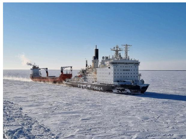
Os quebra-gelos são equipados com um sistema de aspersores de ar: o ar comprimido liberado por bicos localizados abaixo da linha d'água lubrifica o casco, reduzindo o atrito com o gelo e melhorando o desempenho do navio em condições adversas. Cada quebra-gelo é equipado com um reator nuclear KLT-40M.
